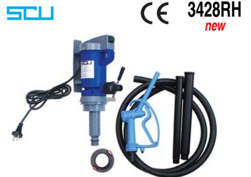
Indicata per nafta e gasolio (non per benzina e olio di colza). Motore monofase 230 V. Tubo di aspirazione lungh. m 1, con filtro e attacco per fusti G 2".
